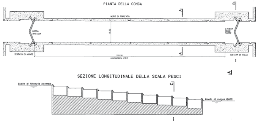
Dall'alto, pianta della conca di navigazione tipo; sezione del sistema a scala per la risalita dei pesci; pianta e sezione della centrale idroelettrica. In basso, pianta del primo sbarramento.
