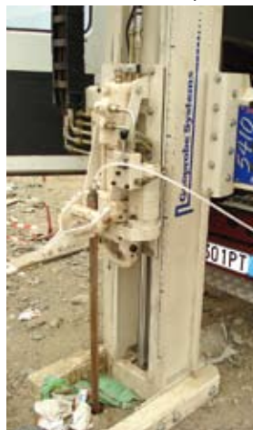
Figura 2 - Campionamenti in discarica mediante Geoprobe
