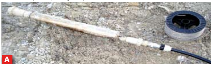
Figura 9 - Eiettore pneumatico installato nei pozzi del campo prove (Immagine A) e prova di utilizzo dell'eiettore in cui si nota la fuoriuscita del percolato estratto dal pozzo (Immagine B)
