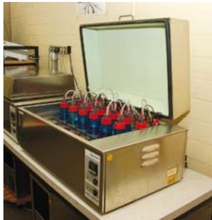
Figura 5 - Respirometro Sapromat, utilizzato per la determinazione dell'indice respirometrico
