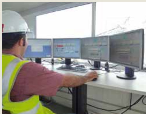
Software di funzionamento, automazione Donner con 4 monitor per gestire 2 mescolatori, gruppo aggregati in comune e tutte le bolle
