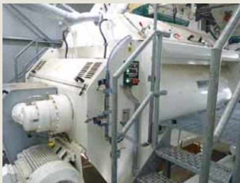
Mescolatore a doppio asse orizzontale (MSO 6000) con 4,5 m 3 di calcestruzzo reso ogni ciclo
