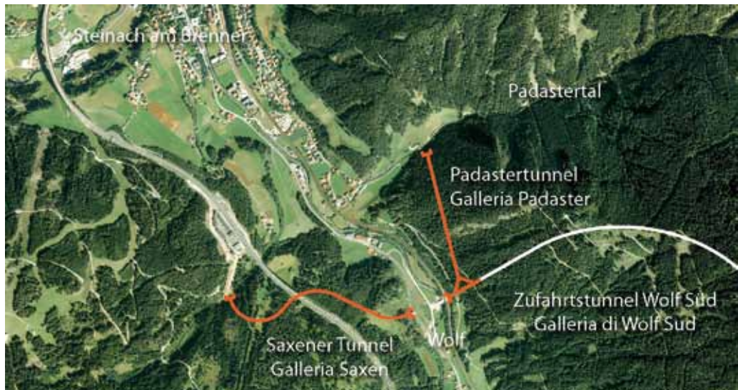
Fotopiano del cantiere di Wolf con indicate le due gallerie di servizio di Padaster e Saxen, e veduta del collegamento viario della Saxen con l'autostrada
