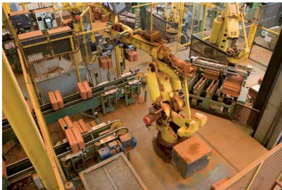
In seguito le tegole vengono reggiate a gruppi di sei allo scopo di facilitare il trasporto e la posa. I pacchetti reggiati vengono poi manipolati da altri due robot che li depongono su due banchi di preparazione formando uno strato del pacco finale. Una terza coppia di robot autoalimentano i pallet in legno da due distributori laterali e li posizionano sulle linee di uscita.
