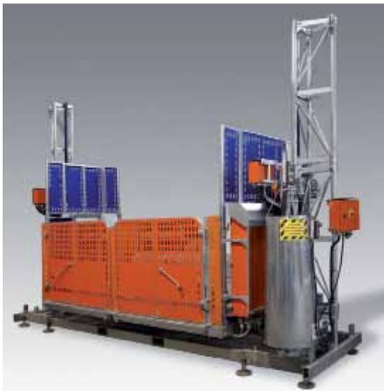
Qui è posizionato anche il commutatore (con chiave) che permette l'utilizzo come Piattaforma di Trasporto (velocità 12 m/min) o Montacarichi (velocità 24 m/min). Il basamento (zincato a caldo) con i relativi vitoni di livellamento, è di dimensioni minori dell'ingombro della cesta, per facilitarne il posizionamento anche nei luoghi più angusti.
