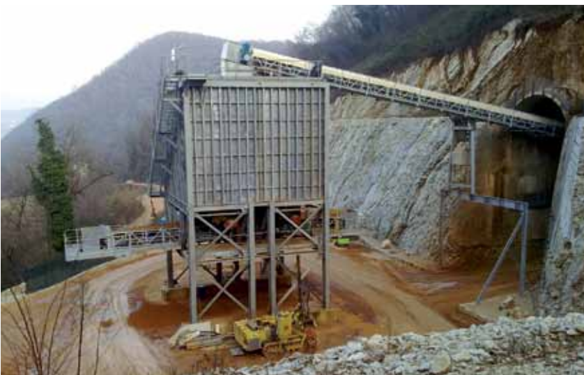
Tramoggia di caricamento automatico del calcare
