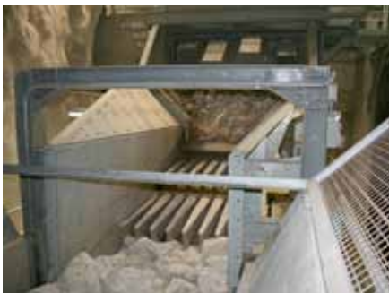
Alimentatore a carrello idraulico e vaglio grossatore primario
