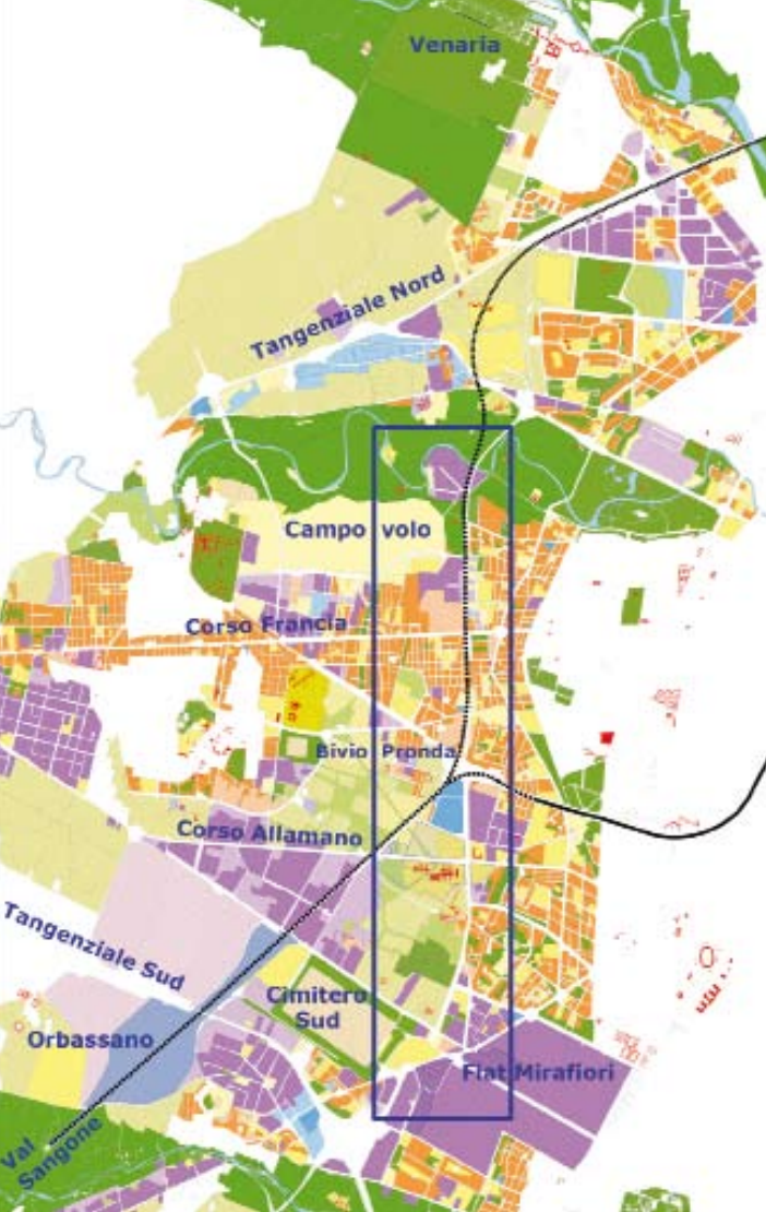
Schema dell'attraversamento ferroviario del nodo di Torino nell'ipotesi di una nuova linea per Lione che passi dall'interporto di Orbassano e la val Sangone
