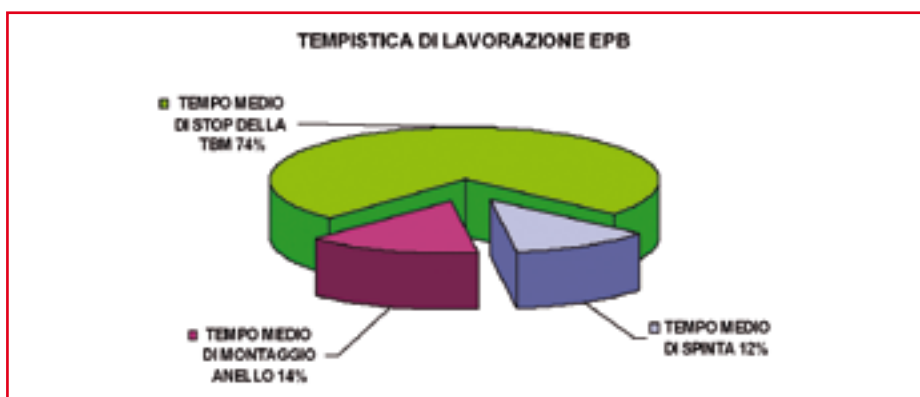
Figura 26 - Le tempistiche di lavorazione della TBM sulla prima sub-tratta Marconi-Nizza
