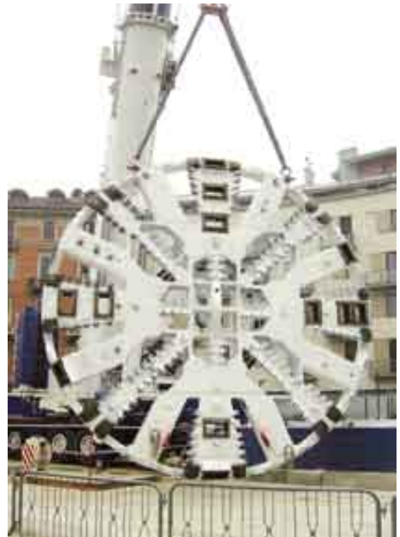
Figura 8 - La testa della EPBMs S415 in fase di montaggio
