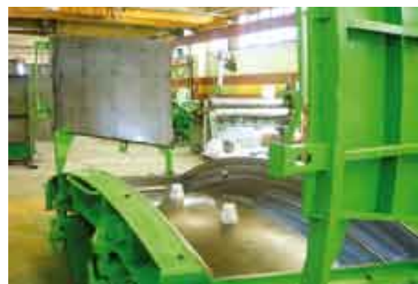
Figura 11 - Particolare di uno dei casseri utilizzati nello stabilimento della IPA Precast di Pavia per la produzione dei conci di rivestimento galleria Lotto 2
